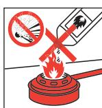
Den Pastenbrenner nie in brennendem oder heißem Zustand nachfüllen. Den Brenner öffnen und den Brennspritzeneinsatz nur in abgekühltem Zustand wieder befüllen.
