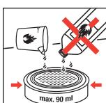
Brennspriteinsatz einlegen (Löcher nach oben) und Brennsprit bis zum Lochsieb (max. 90 ml) mittels Messbecher einfüllen. Nicht direkt mit der Flasche auffüllen (Verschüttungsgefahr).
