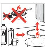
Den Pastenbrenner erst anzünden, wenn der Drehschieber aufgesetzt ist, sich Pastenbrenner mit dem Brennspritzeneinsatz im Rechaud befinden und wenn alle Gegenstände in unmittelbarer Nähe einen sicheren Abstand zum Gerät halten.
