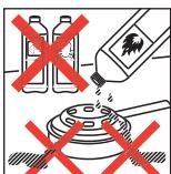
Der Brennspritzeneinsatz in Kombination mit einem Pastenbrenner darf nur mit Brennspritzen betrieben werden. Bei Verwendung von falschen Brennstoffen wie Benzin besteht Verbrennungs- und Explosionsgefahr.
