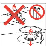
Der Pastenbrenner darf erst angezündet werden, wenn sich das Rechaud am dafür vorgesehenen Ort, auf einer flachen Ablage (Tisch), befindet. Der Brenner darf nicht der Hand angezündet werden.
